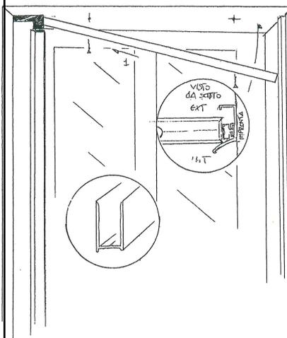
6 Infilare la guida telescopica dentro la guida a U e regolare la guida tramite la barra maniglia della zanzariera
