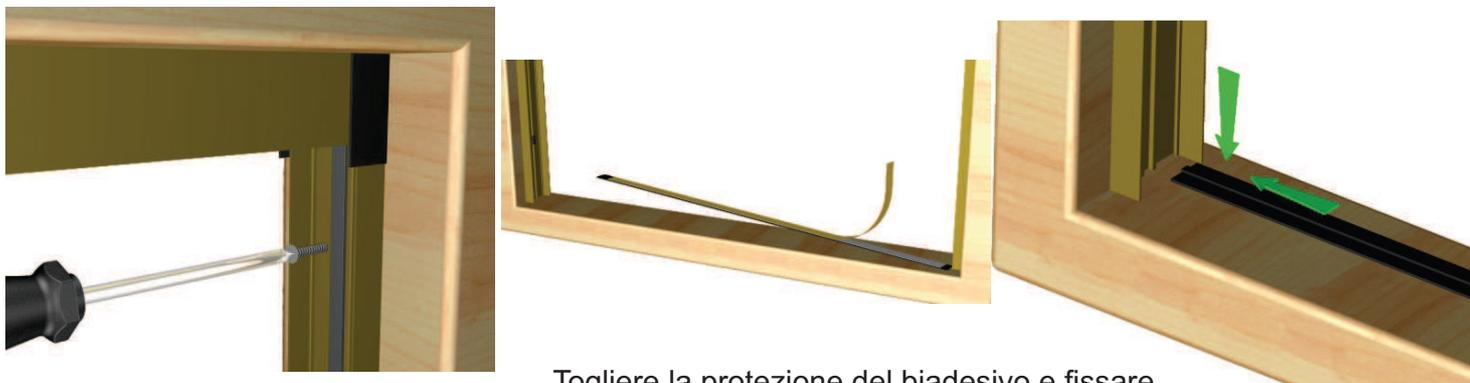
Togliere la protezione del biadesivo e fissare la guida al centro dei compensatori
