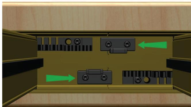
Inserire le guide in diagonale nel compensatore e spingere verso il cassonetto fino alla gancio con la testata portare le maniglie in avanti per allinearle poi spostare i giunti al centro delle guide per congiungerle, fissarli tramite i grani m 5 x 10
