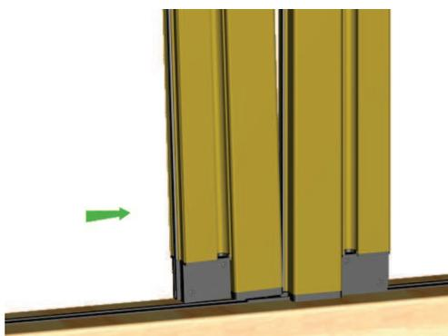
Inserire in diagonale le guida superiore nel compensatore e spingere verso il cassonetto fino alla gancio con la testata e portarle all'interno del compensatore allineandole .
