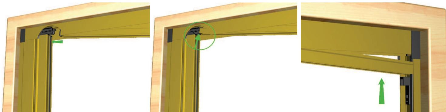
Inserire in diagonale la guida superiore nel compensatore e spingere verso il cassonetto fino alla gancio con la testata e portarla all'interno del compensatore allineandola .
